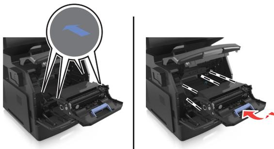
**7** Führen Sie die Tonerkassette in den Drucker ein, indem Sie die seitlichen Führungen der Kassette an den Pfeilen an den seitlichen Führungen im Drucker ausrichten.
