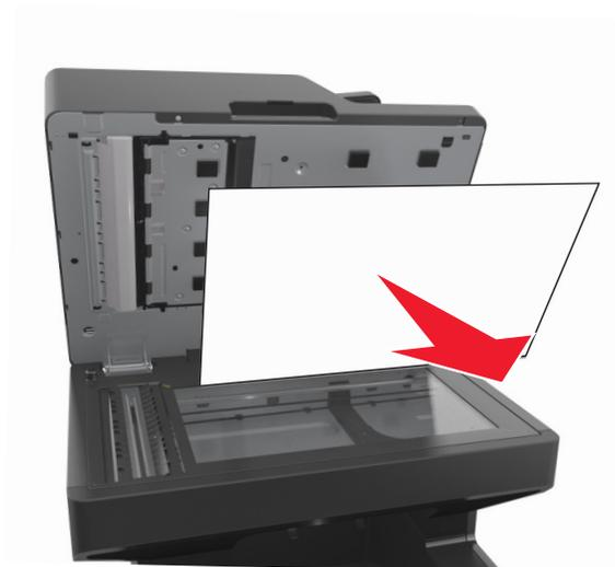
4 Öffnen Sie die Klappe an der Unterseite der ADZ.
