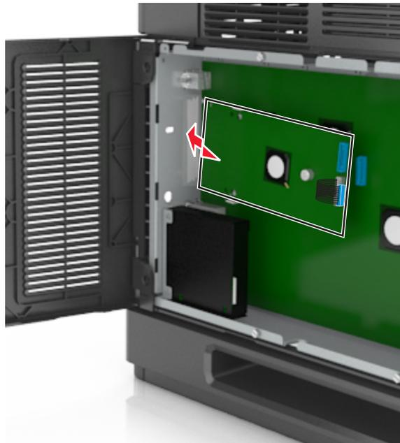
**Hinweis:** Halten Sie den ISP in einem Winkel über der Kunststoffhalterung, sodass alle hervorstehenden Anschlüsse in die ISP-Öffnung im Rahmen passen.
