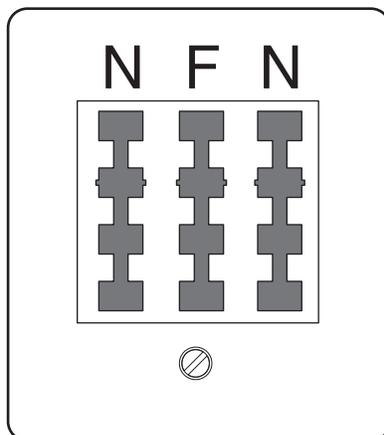
Schließen Sie den Drucker an einen beliebigen N-Anschluss an.
