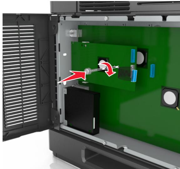
**Hinweis:** Drehen Sie die Schraube im Uhrzeigersinn, um den ISP zu befestigen, aber ziehen Sie sie noch nicht fest.
