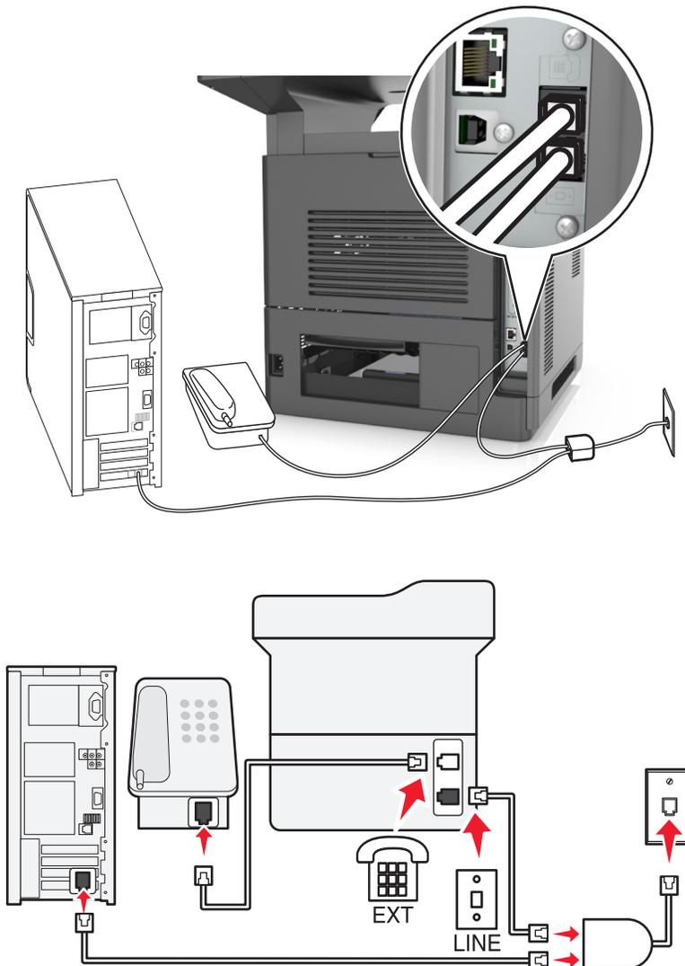
Durch DSL wird Ihre normale Telefonleitung in zwei Kanäle unterteilt: Sprache und Internet. Telefon- und Faxsignale nutzen den Sprachkanal, während Internet-Signale den anderen Kanal verwenden. Auf diese Weise können Sie dieselbe Leitung für analoge Sprachanrufe (einschließlich Faxnachrichten) und digitalen Internet-Zugriff verwenden.
