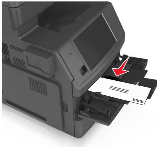
**Warnung - Mögliche Schäden:** Es dürfen keine Umschläge mit Briefmarken, Metallklammern, Haken, Fenstern, Fütterung oder selbstklebenden Aufklebern verwendet werden. Durch solche Umschläge kann der Drucker schwer beschädigt werden.
