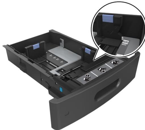
**3** Entriegeln Sie die Längenführung, drücken Sie die Führung zusammen, und schieben Sie sie in die für das einzulegende Papierformat vorgesehene Position.
