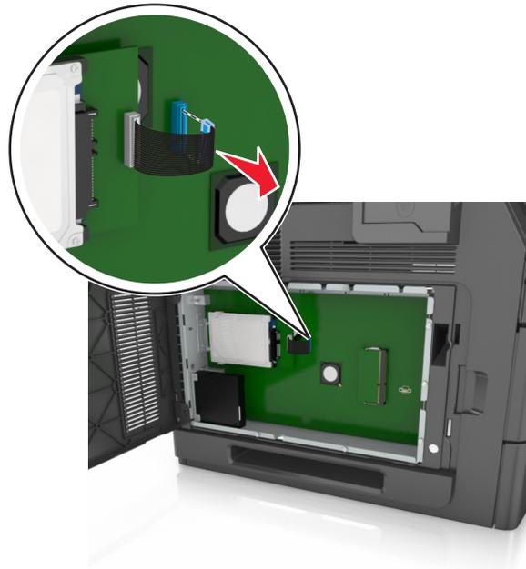
**3** Entfernen Sie die Schrauben, mit denen die Druckerfestplatte befestigt ist.
